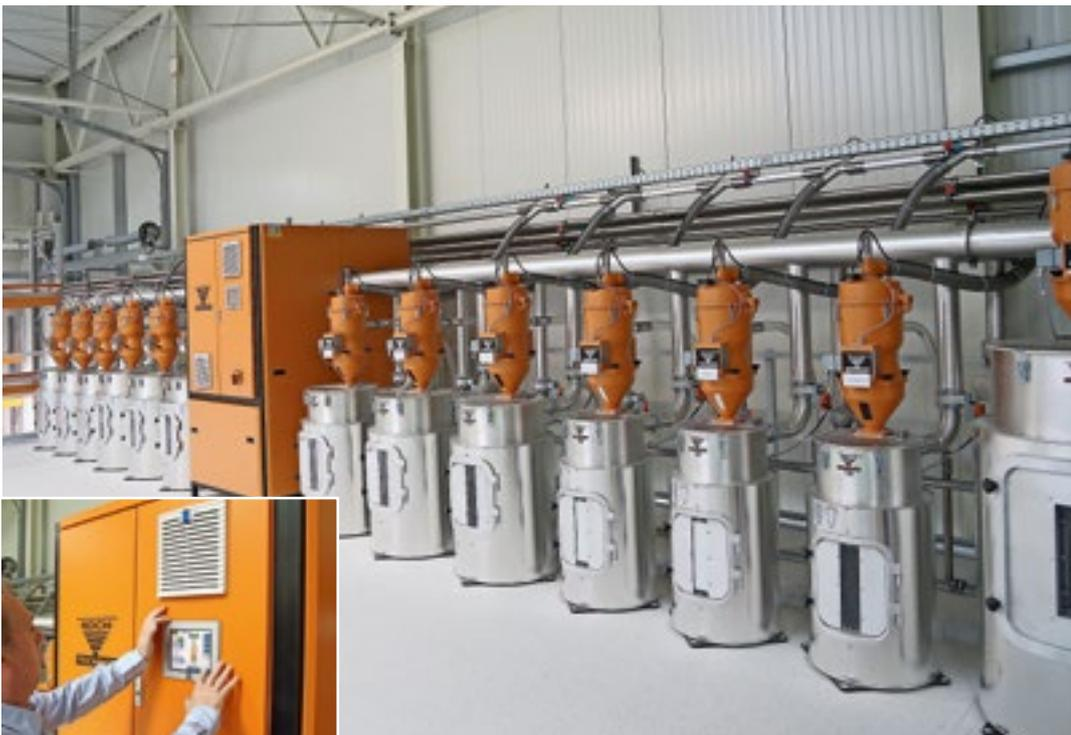
Der **CKT 500-Trockenlufttrockner** ist für die **Trocknung hygroskopischer Materialien** optimiert. **Direkt am Granulattrockner** können alle Parameter über ein **Touchpanel** editiert werden; **zusätzlich wird die gesamte Materialversorgung einschließlich Granulattrocknung über eine Visualisierungssoftware gesteuert** Fotos: Koch-Technik
