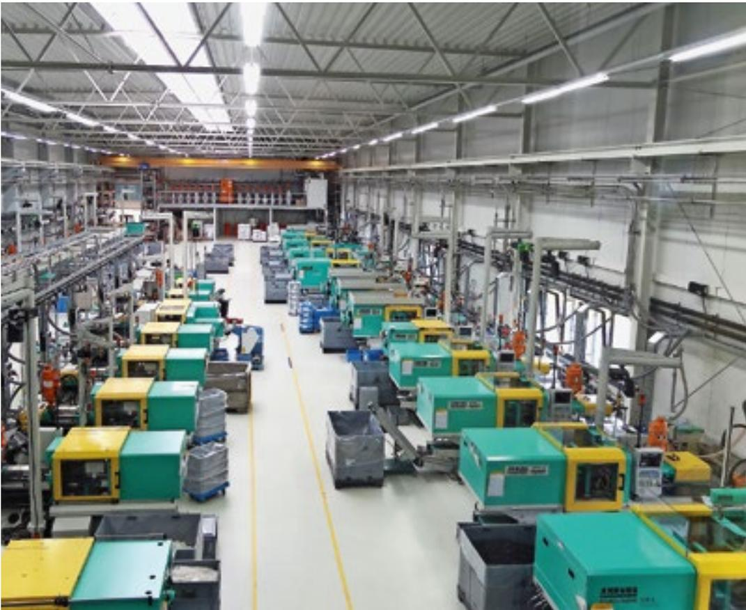
**Für die Materialversorgung der 34 Spritzgießmaschinen wurden mehrere Kilometer Edelstahlrohr entlang der Hallenperipherie verlegt. Auf den Spritzgießmaschinen sind Förderabscheider installiert, die das geförderte Rohmaterial von der Förderluft trennen** Foto: Koch-Technik
